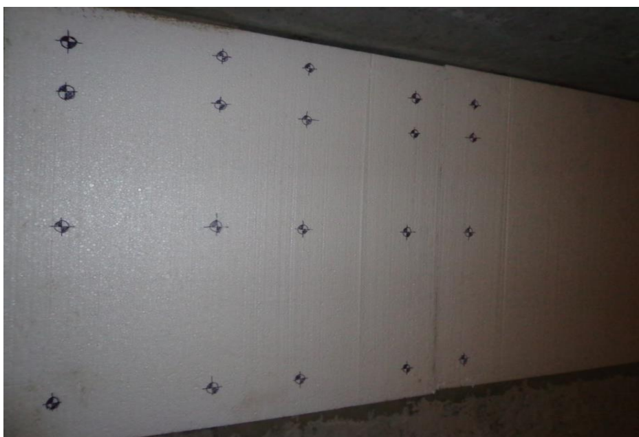
Расстановка маркеров бесконтактного измерения температуры в натуральных условиях.
